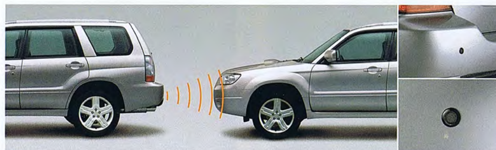
87 Ultrasonic Parking aid (fram & bak) SEWAYA2100, SEWAYA2000 Sensorstyrd. *Kan ej kombineras med hörnskydden.
