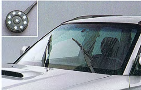
49 Regnsensor SEWAYA8000 E Aktiverar automatiskt torkarbladen.
