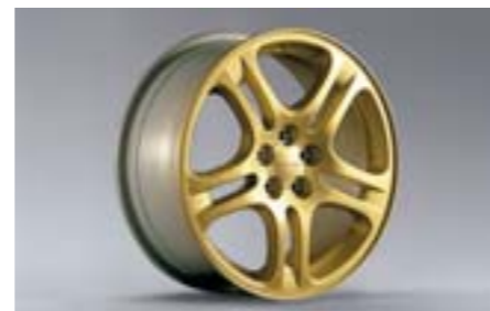
21 Aluminiumfälg 5-ekrad, Guld (17") 28111FE021 W 17x7JJ offset 55 Däck stl: 215/45R17
