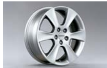
26 Aluminiumfälg 6-ekrad (16") SECWFE4001 E 16x6.5JJ offset 55 Däck stl: 205/55R16
