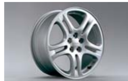
22 Aluminiumfälg 5-ekrad, silver (17") 28111AE019 W 17x7JJ offset 55 Däck stl: 215/45R17
