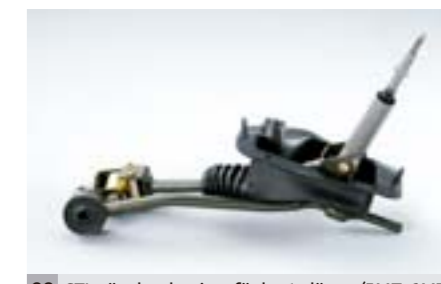
88 STI, växelmekanism för korta lägen (5MT, 6MT) C1010AG001, C1010AG101 W Förutom Dual Range fordon.
