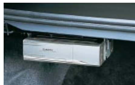
93 CD växlar fäste (Sedan) H6210FE902 W Nödvändig för att montera CD växlare eller Navigationsenhet.
