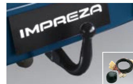
57 Dragkrok, Delbar L1010SE100 W Maximal dragvikt: 1600 kg.
